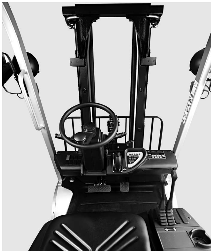
Оптимальный круговой обзор благодаря тонкой конструкции крыши и мачты, обеспечивающих свободу обзора
